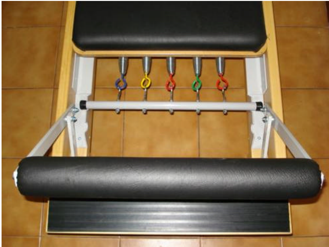
Foto 2. Detalle de los resortes de alta resistencia, identificados con colores.
