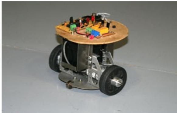
Ilustración 69: Primer prototipo robot Fútbol V1 con driver por relays.
