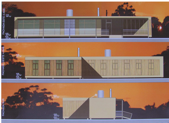
Figs. 7 y 8: Envolvente resuelta con tecnología de caña adaptada a diferentes orientaciones, generando fusión interior- exterior según la necesidad.
