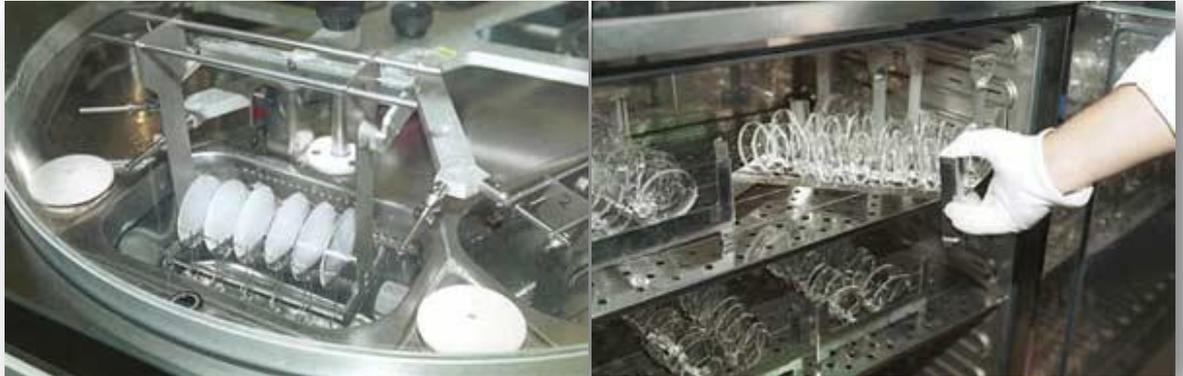
**Imagen 6.** Antes de comenzar el tratamiento, las lentes se someten a una limpieza por ultrasonido en bateas con distintos detergentes. Luego se secan en un horno para eliminar la humedad.
