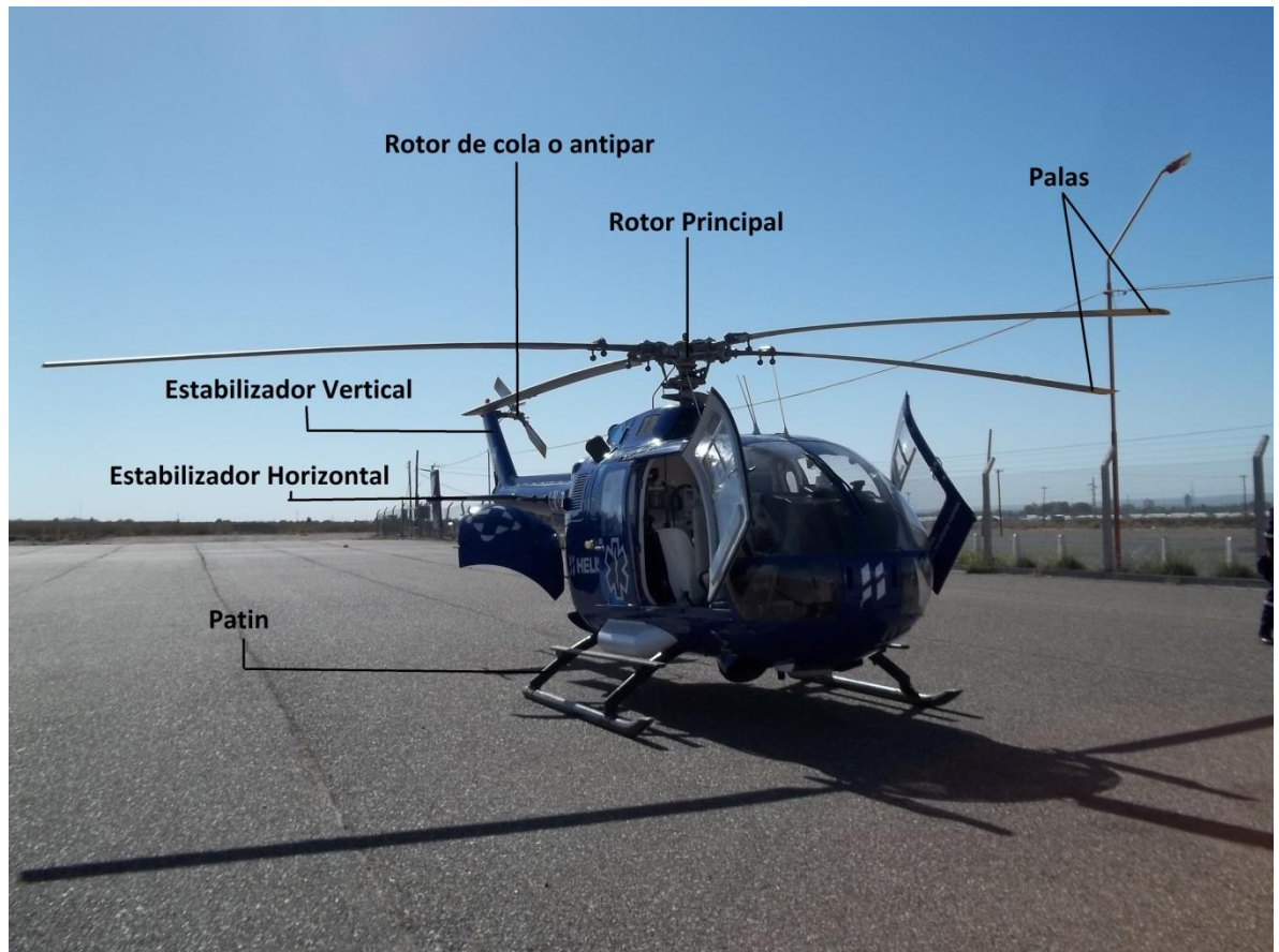
Ilustración 3: Elementos de un helicóptero, BO 105 (LV-ZZW) propiedad de Air Energy Services (Helisafe)
