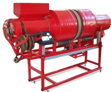
PRODUCCION A ESCALA PILOTO - SECADORA Y LIMPIADORA DE GRANOS DE AMARANTO
