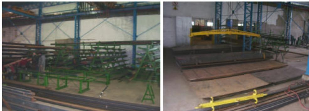
Imagen 1: Depósitos de materia prima; chapas, perfiles, ángulos. Se utilizan puentes grúas para manipularlas.
