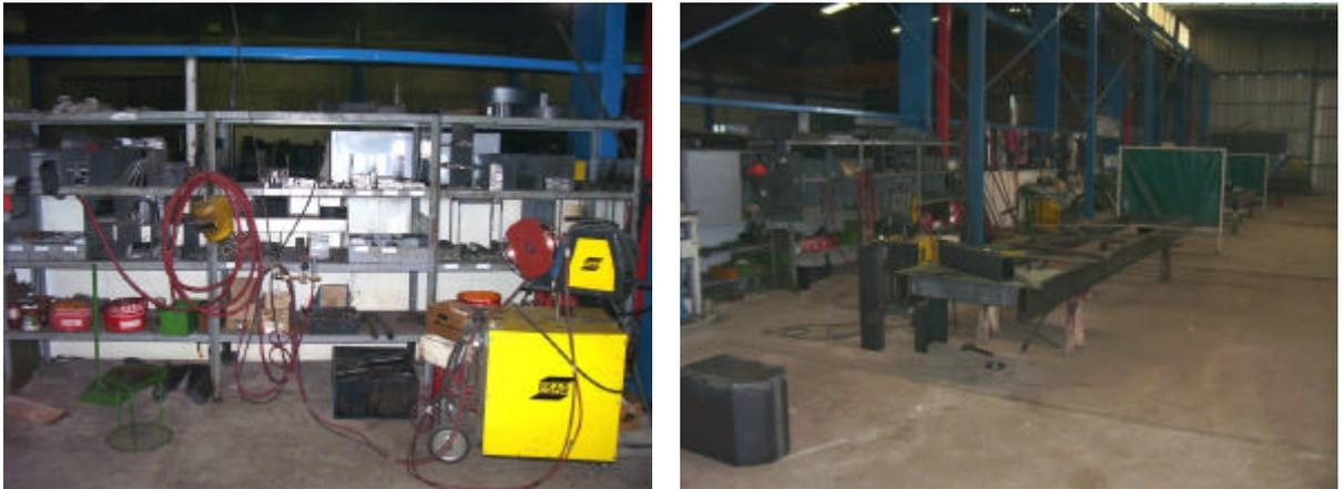
Imagen 11: Maquinaria para realizar el montaje; soldadoras, plasmas.
