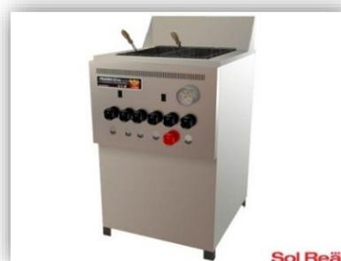
Descripción: Cuerpo acero inox. 430 esmerilado, 2 canastos de 31 X 16 X 12 cm. c/u, 8 inyectores + piloto, Capacidad máxima: aceite 22 Lts / agua 2 Lts / sal 1Kg.
