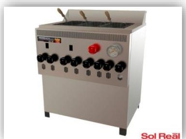
Descripción: Cuerpo acero inox. 430 esmerilado, 3 canastos de 24 X 18 X 12 cm. c/u, 12 inyectores + piloto, Capacidad máxima: aceite 30 Lts / agua 12 Lts / sal 1 1/2 Kg.
