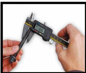
1) Medición del diámetro del tornillo.
