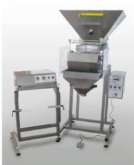
La función de la balanza es que sea preciso el pesado de cada bolsa ya envasa. La capacidad es de 6 a 8 bolsas por minuto, dependiendo de la velocidad de la persona. Las galletas se envasarán en bolsas pre confeccionadas para luego ser envasadas dentro de una caja con capacidad de 15 a 20 bolsas aproximadamente. Las cajas ya cerradas se acumularán en pallets para luego ser despachadas a los distribuidores.
