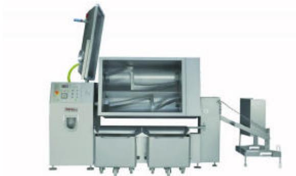
El preparado líquido de la batidora se introduce dentro de la amasadora ZZ obteniendo así el amasado final. El proceso cuenta con un tiempo estimado de 12 a 15 min. Segundo paso se ubica el amasado en la formadora de galletas rotativa, está, a través de un rolo, brinda el formado final de la galleta.
