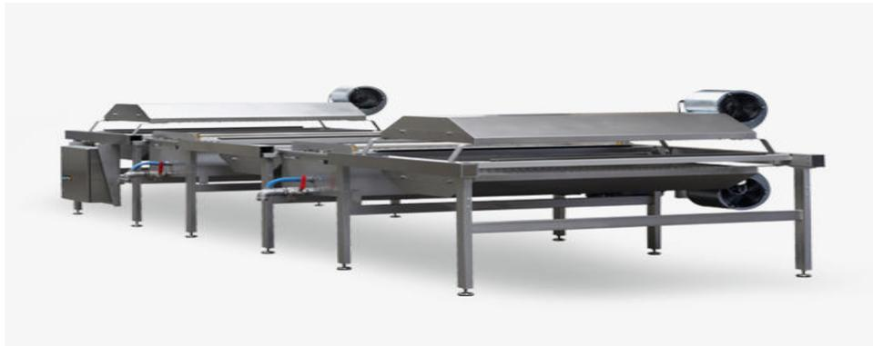
Una vez enfriada la galleta la misma cinta transportadora la ubica en un apilador de galletas. Este apilador facilita el próximo proceso de envasado ya que la galleta está acomodada para ser transportada y reduce volúmenes.
