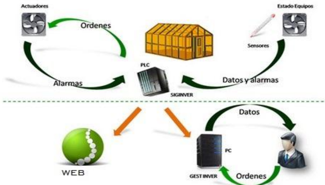
Figura 5: Esquema ilustrativo del funcionamiento del Producto 1
