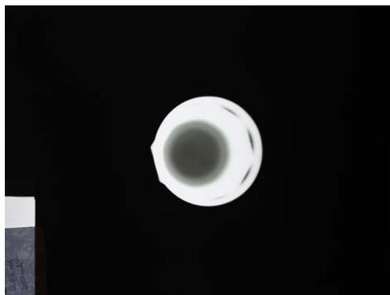
Como se puede observar, la imagen central no se observa distorsionada ni deformada, siendo esto indicativo de que el rayo central coincide con la cruz dibujada en el acrílico del
