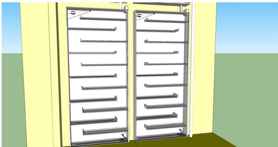
Los reservorios son de plástico reciclado. Fueron diseñados internamente en forma de zig-zag para cuando escurra el agua contenida en ellos con un orden ralentizador. En la parte superior posee 3 orificios de 110 mm de diámetro para el ingreso de agua proveniente del sistema ralentizador, en caso de ajuste o cambio en el ingreso del líquido por alguna decisión de proyecto.
