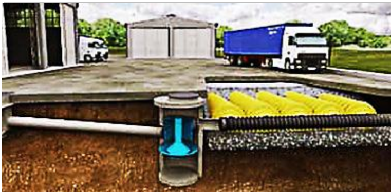
Figura 34: Downstream Defender y cámaras de infiltración.
